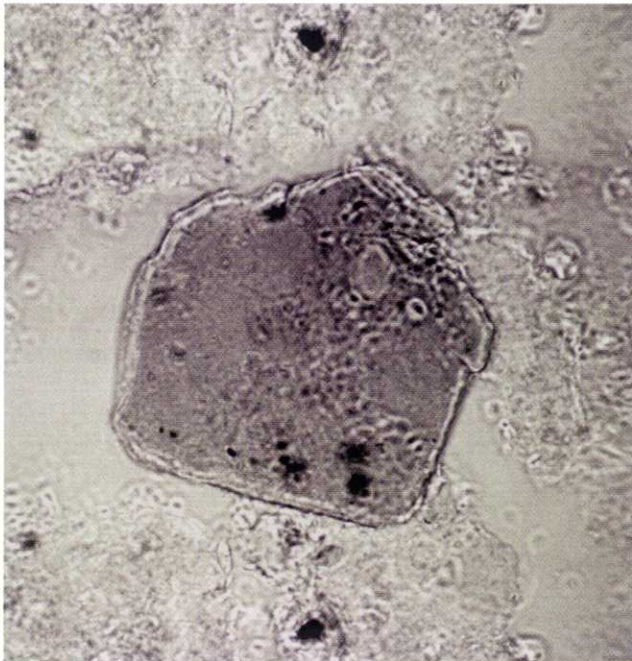
TERRANA®-Partikel mit bakteriellem Aufwuchs (Aufnahmen: TUM Wagner, Phasenkontrast, Vergr 1000x)
